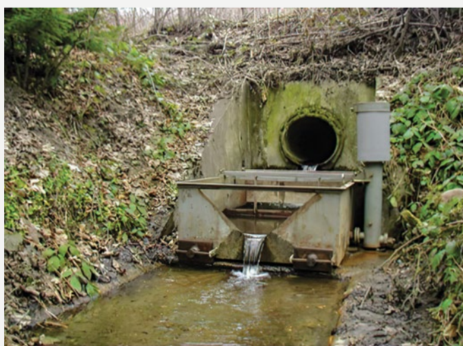
Vízhozamot mérő bukóláda a Rák-patak 92 ha-os mellékvölgyében, a Vadkan-árokban (©KuM)
