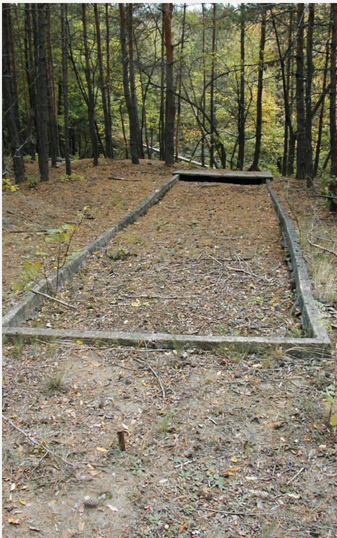
Felületi erózió meghatározása mintaparcellán az ERTI Kiszána melletti Dolina-völgyben kialakított kísérleti területén (©KP)
