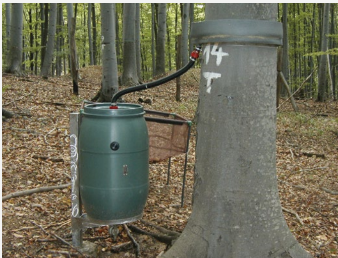
Törzsi lefolyás mérése az ERTI kísérleti területén a Mátrában (©KP)
